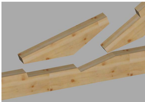
Figura B.28: Encaix de compressió de barbeta, peça auxiliar obliqua i rebaix.
