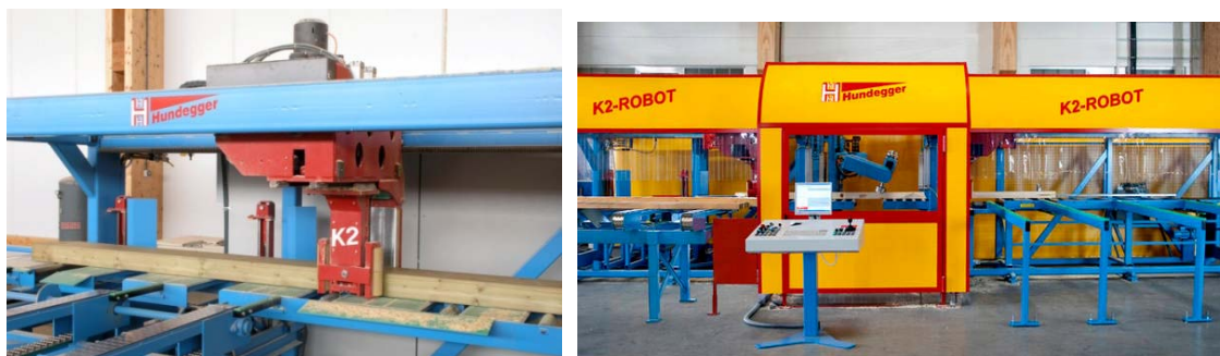
Figura B.23: Imatges de la màquina de mecanització K2 de Hundegger.
