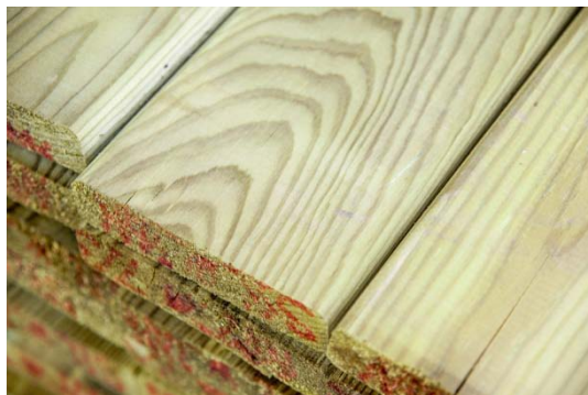
Figura A.18: Imatge de perfil tractat amb sals de coure.
