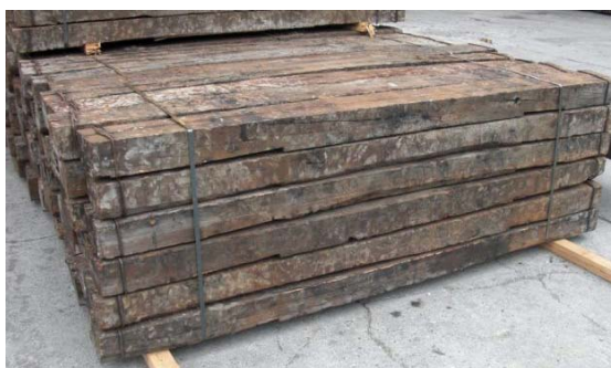
Figura A.19: Imatge de travesses tractades amb creosotes.
