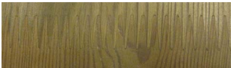
Figura A.36: Imatge de la unió anomenada FingerJoint.
