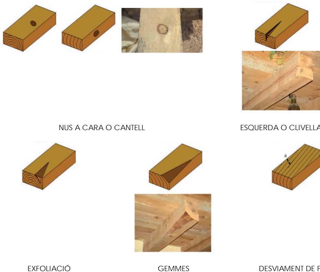
Figura 2.18: Principals defectes de qualitat de la fusta. [4]
