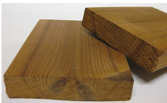
Figura A.27: Imatge d'una fusta tractada mitjançant termo - tractament.
