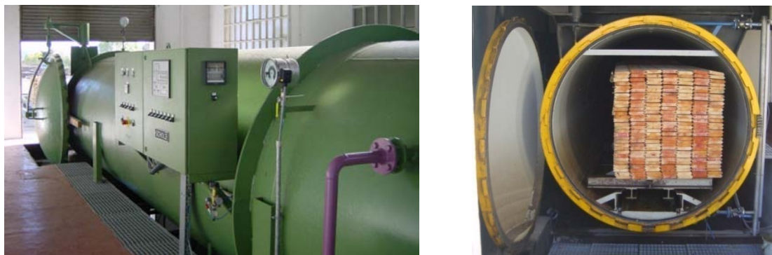
Figura A.23: Caldera tipus de tractament amb pressió a l'autoclau.
