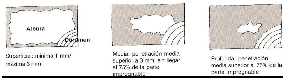
Figura A.33: Tipus de penetració [4].
