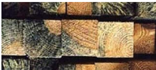
Figura A.13: Imatge de fusta infectada per fongs cromogènics.
